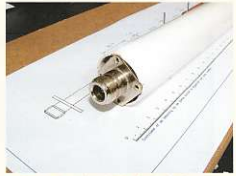
De flens van het chassisdeel valt in de uitsparingen in de behuizing.
